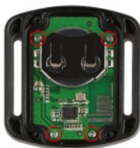
3. Heben Sie die Leiterplatte an und ziehen Sie den Akku heraus, wie in der Abbildung gezeigt.
