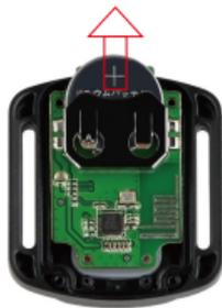
4. Setzen Sie die neue Batterie ein und achten Sie dabei darauf, dass der Pluspol nach oben zeigt.
