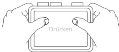
**Hinweis:** Drücken Sie und stellen Sie sicher, dass zwischen den wasserdichten Streifen des wasserdichten Gehäuses kein Spalt vorhanden ist.
