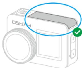
Крышка аккумуляторного отсека плотно закрыта
