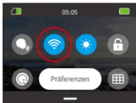
※ Wenn das WLAN der Kamera eingeschaltet ist, schaltet sie sich automatisch aus, wenn sie nicht innerhalb von 3 Minuten mit der App verbunden ist. Um Ihre Kamera mit der App zu verbinden, schalten Sie bitte das WLAN der Kamera erneut ein.
