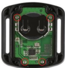
3. Heben sie die leiterplatte an und schieben sie die batterie heraus, wie in der abbildung gezeigt.
