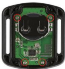
3. Levantar la placa PCB y deslizar la batería hacia afuera, como se muestra en la figura.
