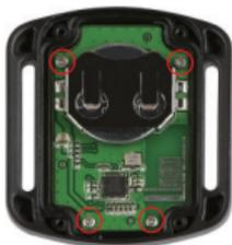
3. 図に示すように、PCBボードを持ち上げ、バッテリーを取り出します。
