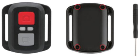
2. PCBボード上の4本のネジを取り外します。
