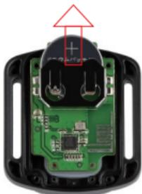
4. Setzen Sie die neue Batterie ein und achten Sie dabei darauf, dass der Pluspol nach oben zeigt.
