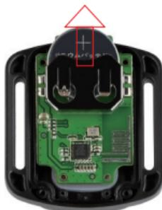
4. Instalar la batería nueva, manteniendo el polo '+' hacia arriba.
