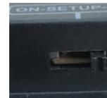
Faites glisser l'interrupteur de mode de l'appareil photo Wildlife sur la position RÉGLAGES pour commencer le mode test. Dans le mode Photo ou Vidéo, appuyez sur le bouton MENU pour appeler le menu.
