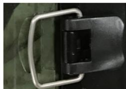
Pour ouvrir l'appareil photo, défaitez les deux loquets de verrouillage latéraux tel que montré à la Fig. 1.
