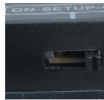
Deslice el cambio de modo de la cámara de caza a la posición de SETUP para iniciar el modo de prueba. En el modo Foto o Video, presione el botón MENU para invocar el menú.
