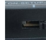
Schieben Sie den Modus Schalter der Wildkamera in die Position SETUP, um den Testmodus zu starten. Im Foto- oder Videomodus drücken Sie die MENÜ-Taste, um das Menü aufzurufen.
