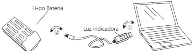
**Nota:** La luz indicadora roja permanece encendida durante la carga y se apaga cuando está completamente cargada.
